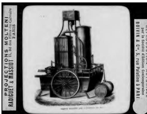
Figura 4. Aparato locomóvil para la destilación del vino. Placa fija.
